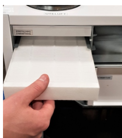
Återställning av överhettningsskydd OBS med ett trubbigt verktyg
